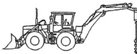
Esempio di terra con trivella
